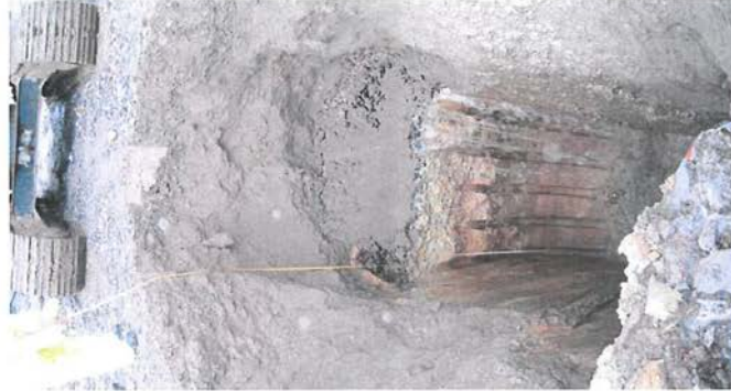
CALICATA C-6 PROFUNDIDAD FINAL = 5,50 MTS.
