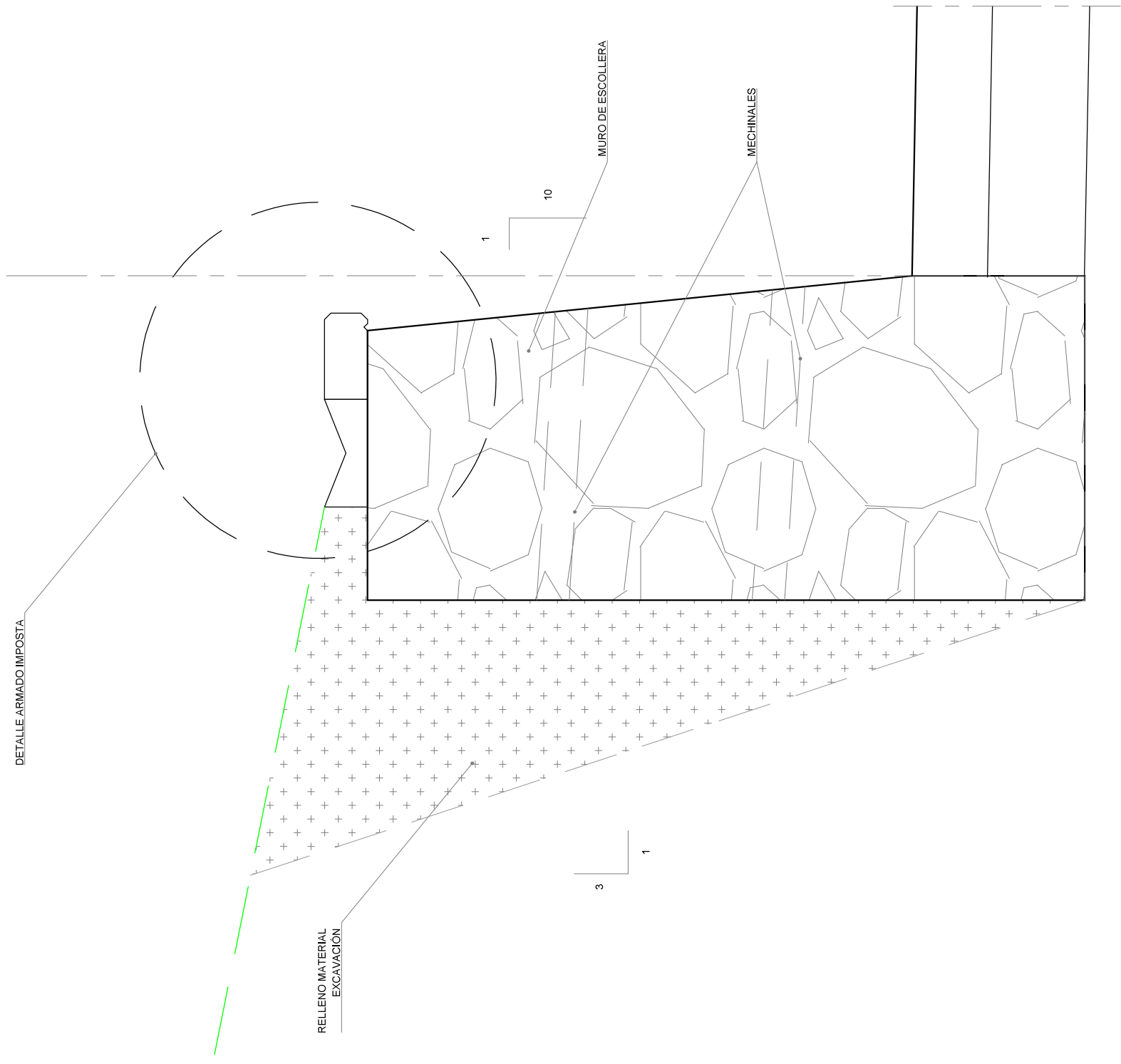
SECCIÓN TIPO - ARMADO IMPOSTA E(A1): 1/12.5 E(A3): 1/25
